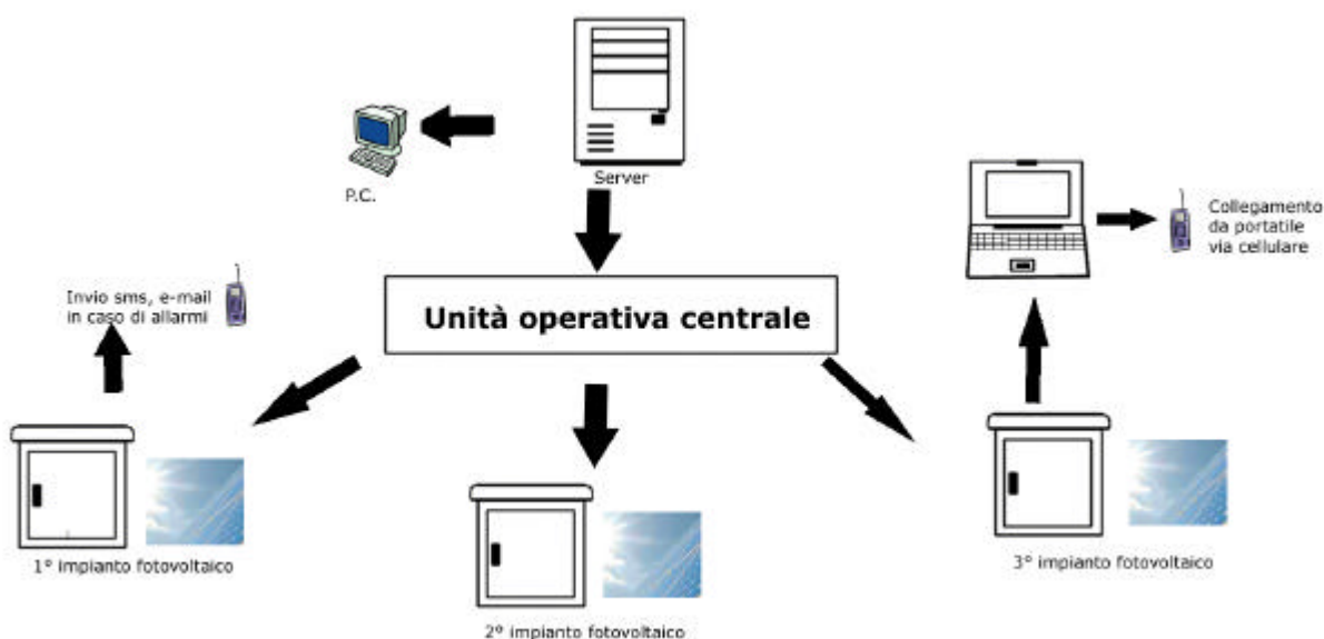
Fig.1 Sistema di telegestione – Architettura generale
